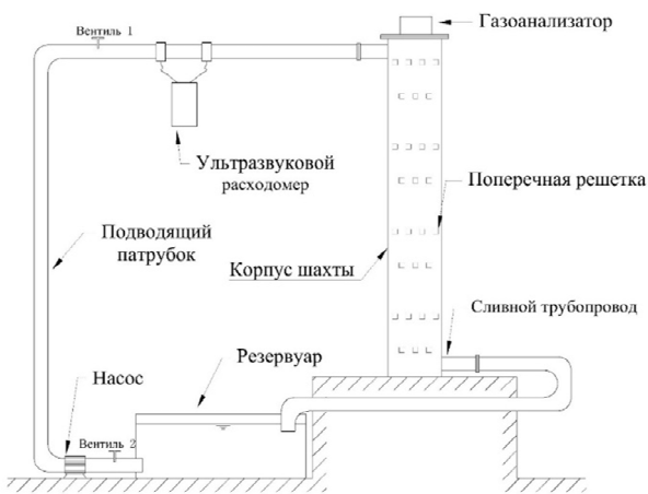
Рисунок 4 - Схема экспериментальной установки перепадной шахты
