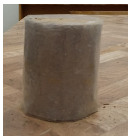
Рисунок 5 - Опытный образец, обмотанный антифрикционным материалом
