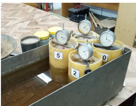
Рисунок 6 - Опытные образцы переуплотненного глинистого грунта в емкости с водой
