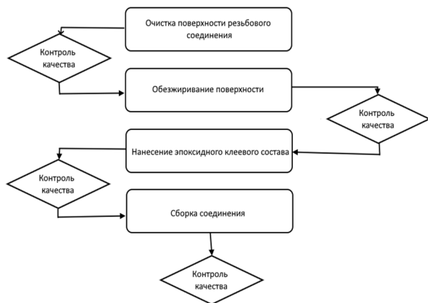
Рис. 1 – Технологический алгоритм сборки муфты
